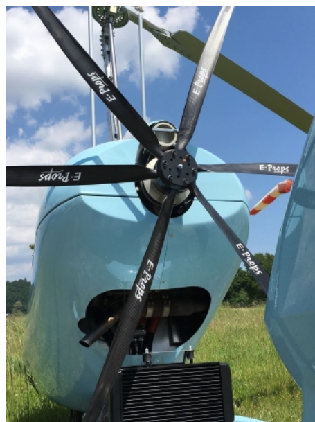
hélice 6-pales Excalibur-6 pour moteurs Rotax famille 912 2,9 kg / diamètres de 168 à 175 cm poussée max = 360 kg @ 2.550 tr/min (150 cv) déphasage des pales = ultra-silencieuse
