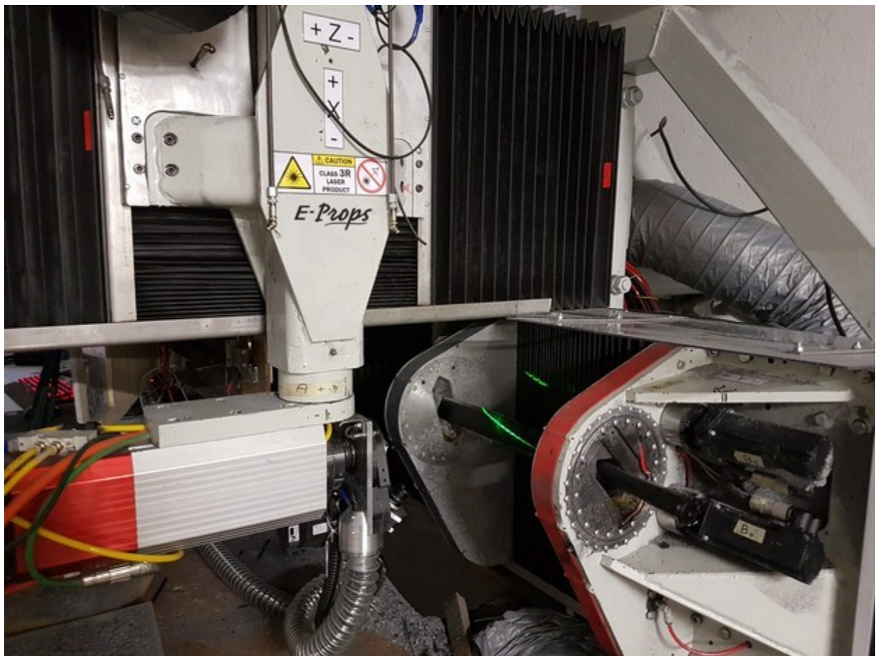
1 pale d'EXCALIBUR-6 dans les pinces horizontales, en cours de scan sur le centre d'usinage TRM-8
