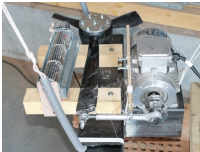
hélice E-Props tripale carbone, moyeu carbone, sur banc d'essais en fatigue
