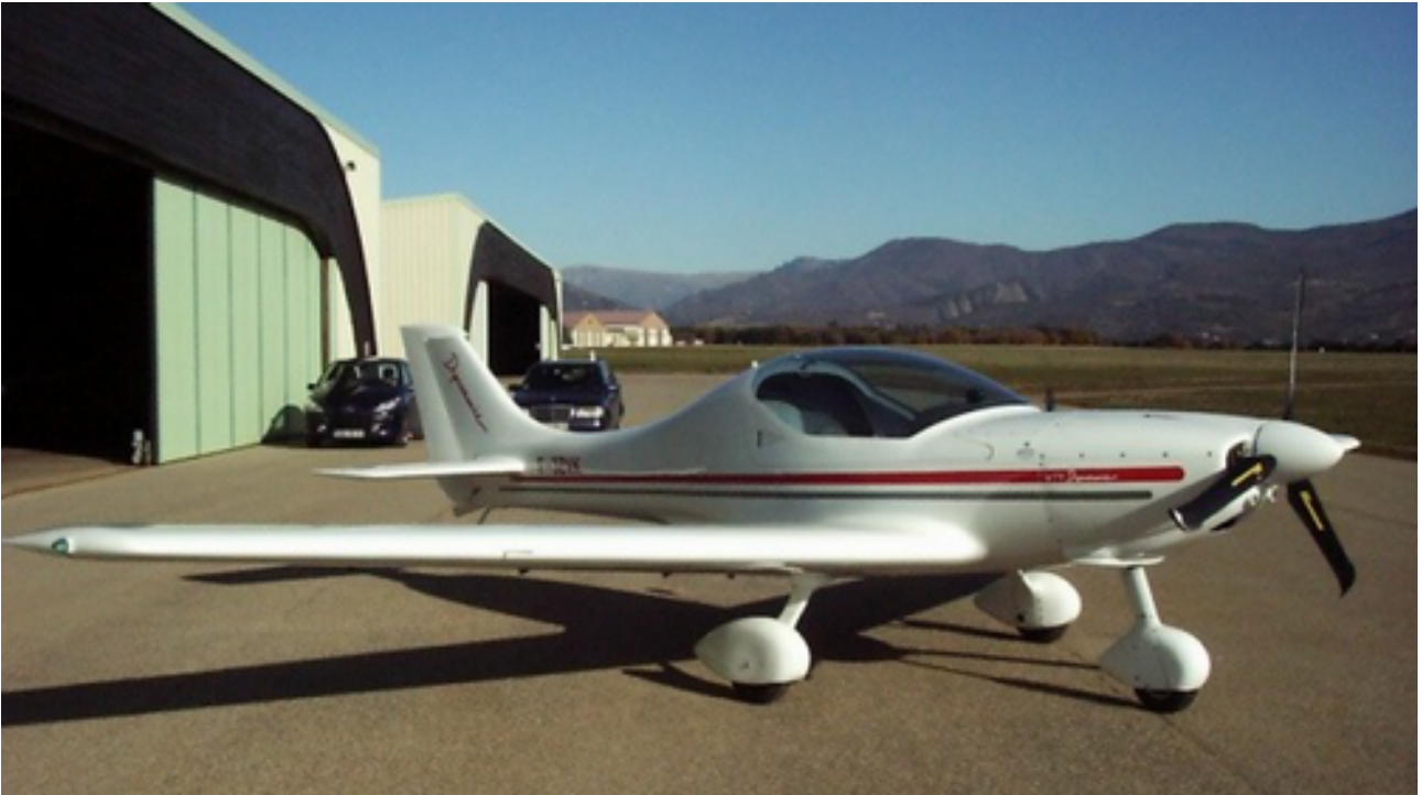
ULM remorqueur WT9 Dynamic, Rotax 912S, hélice de référence
