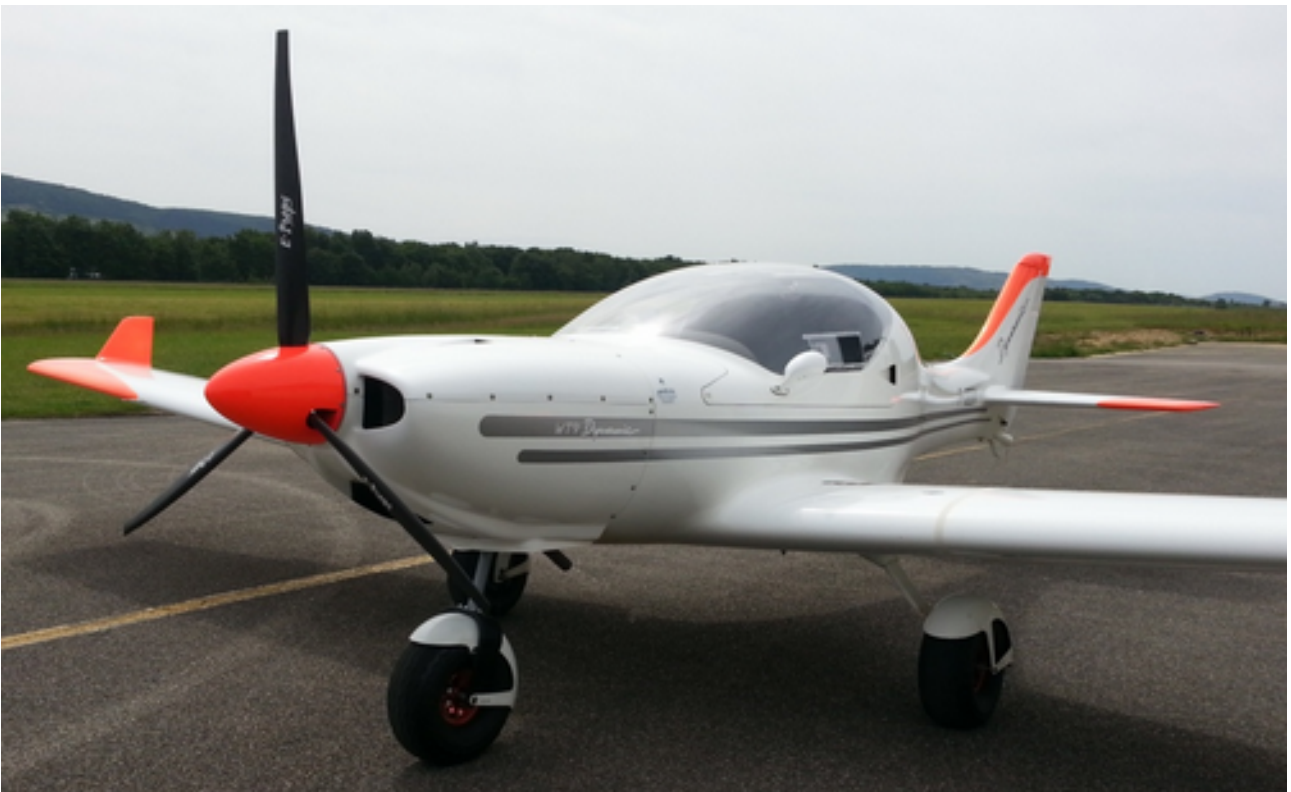
ULM remorqueur WT9 Dynamic, Rotax 912S, hélice E-Props Durandal 100-R
